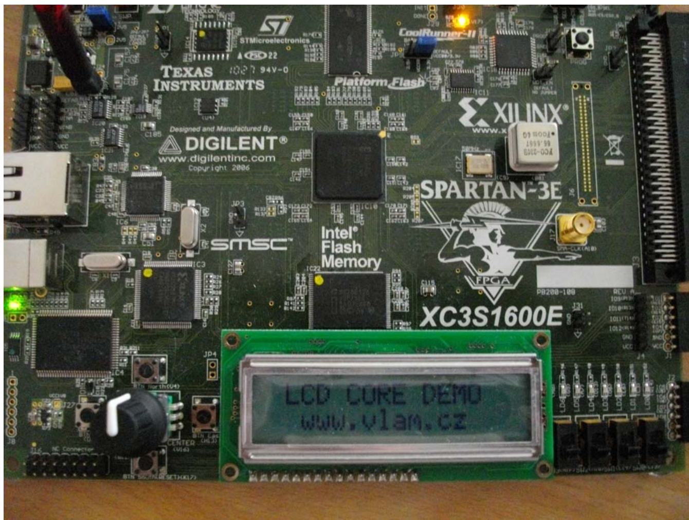
Obrázek 5: Funkční vzorek modulu řadiče dvouřádkového LCD zobrazovače na desce S3E1600
